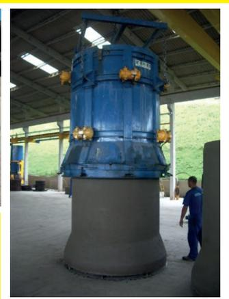
MVU 1500 alta resistencia con vibradores externos / Molde de una pieza
